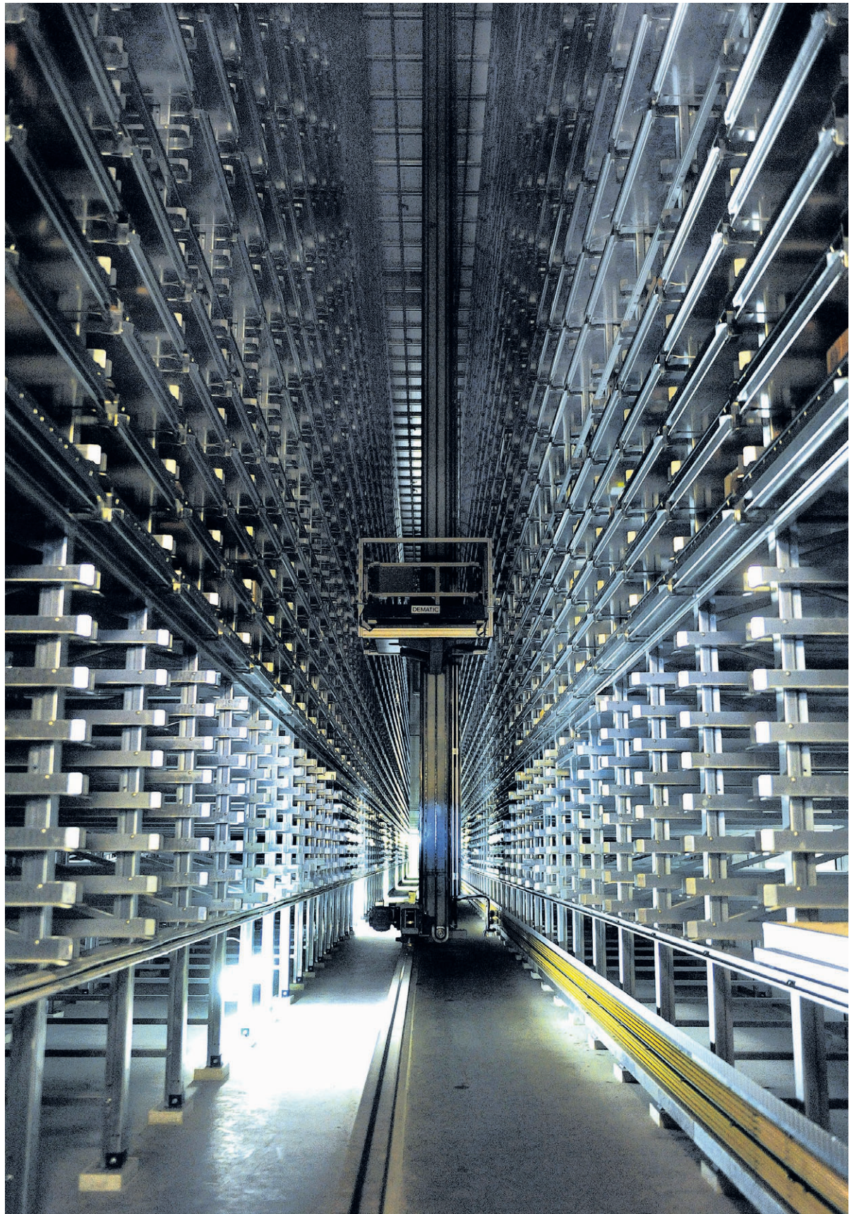
• De geautomatiseerde opslagruimte herbergt zo'n 55.000 voorraadboarden, goed voor de opslag van zo'n 400.000 onderdelen. Al die voorraadboarden bij elkaar beslaan dertien voetbalvelden. foto's Edmund Messerschmidt/het fotoburo
